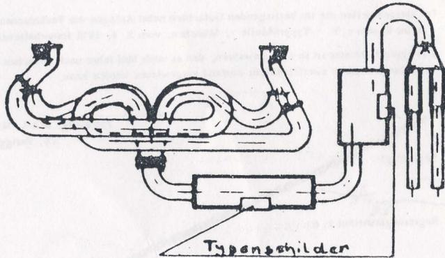
**Einbauanweisung für Auspuffschalldämpfer
